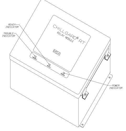
Figure B-1. Relay Module
